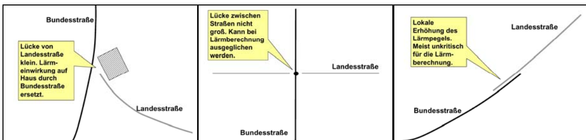
Abb. 44: Geometrische Interoperabilitätsprobleme bei der Integration von Straßendaten mit DGM und Gebäudedaten. In diesen Fällen muss keine Homogenisierung der Daten durchgeführt werden (Quelle: eigene Befragungen siehe Kapitel III.) (Zeichnungen IKG Uni Bonn).
