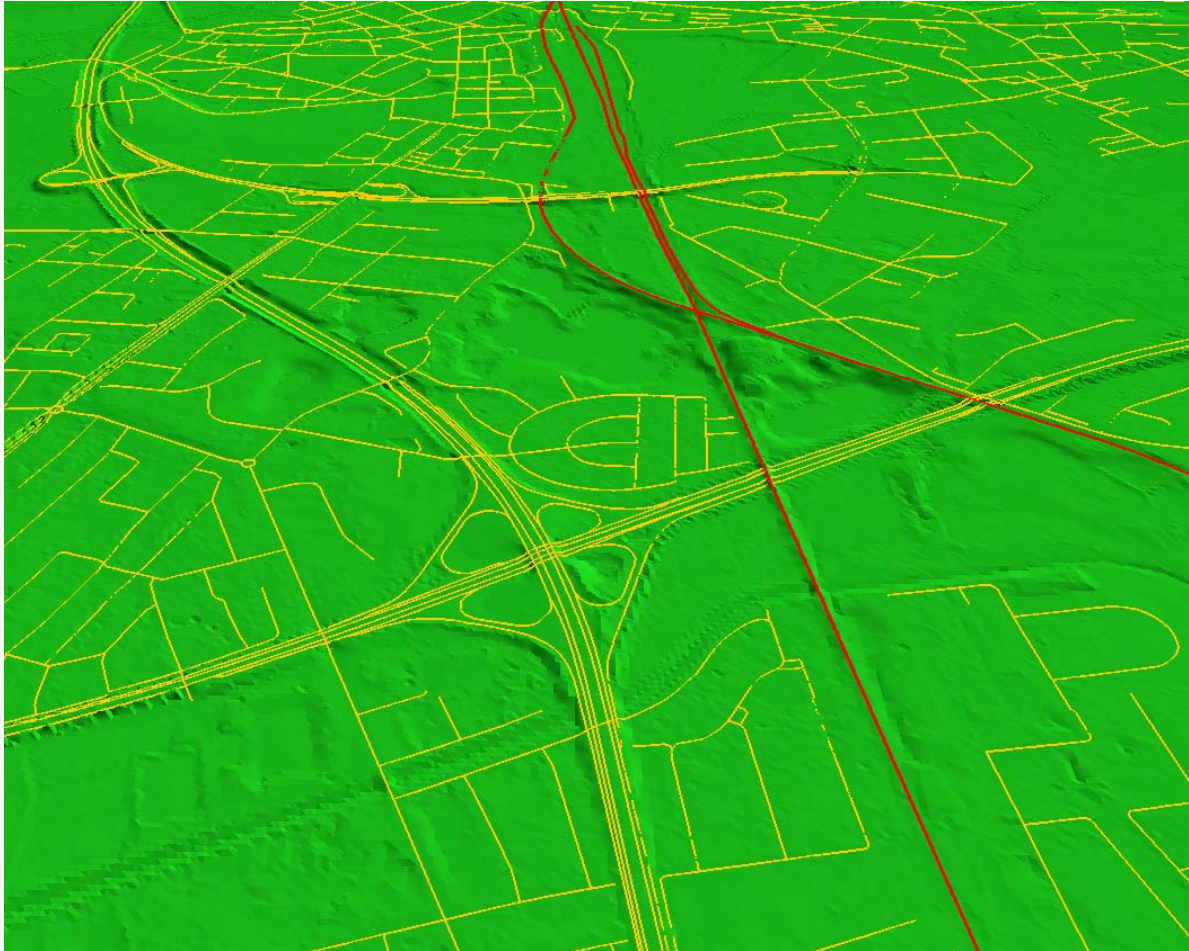
Abb. 17: 3D-ATKIS-Straßendaten (gelb) und –Schienendaten (rot) vom LVerMA NRW im CityGML-Format für die Umgebung des Leverkusener Kreuzes aus dem WFS ATKIS-Daten (Graphik: IGG Uni Bonn).
