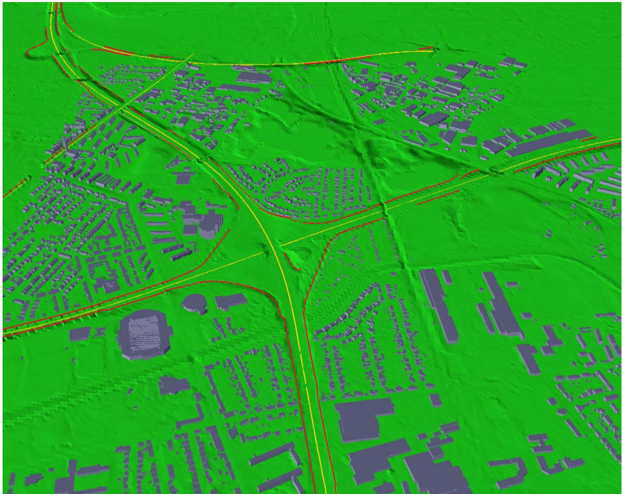
Abb. 20: Straßendaten (gelb) und Lärmschutzwände (rot) von Straßen.NRW im CityGML-Format für die Umgebung des Leverkusener Kreuzes aus dem WFS Straßen.NRW-Daten (Graphik: IGG Uni Bonn).
