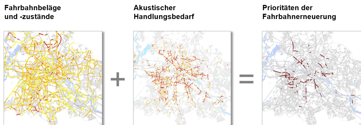
Abbildung 56: Mögliche Priorisierungskriterien für Fahrbahnerneuerungen
